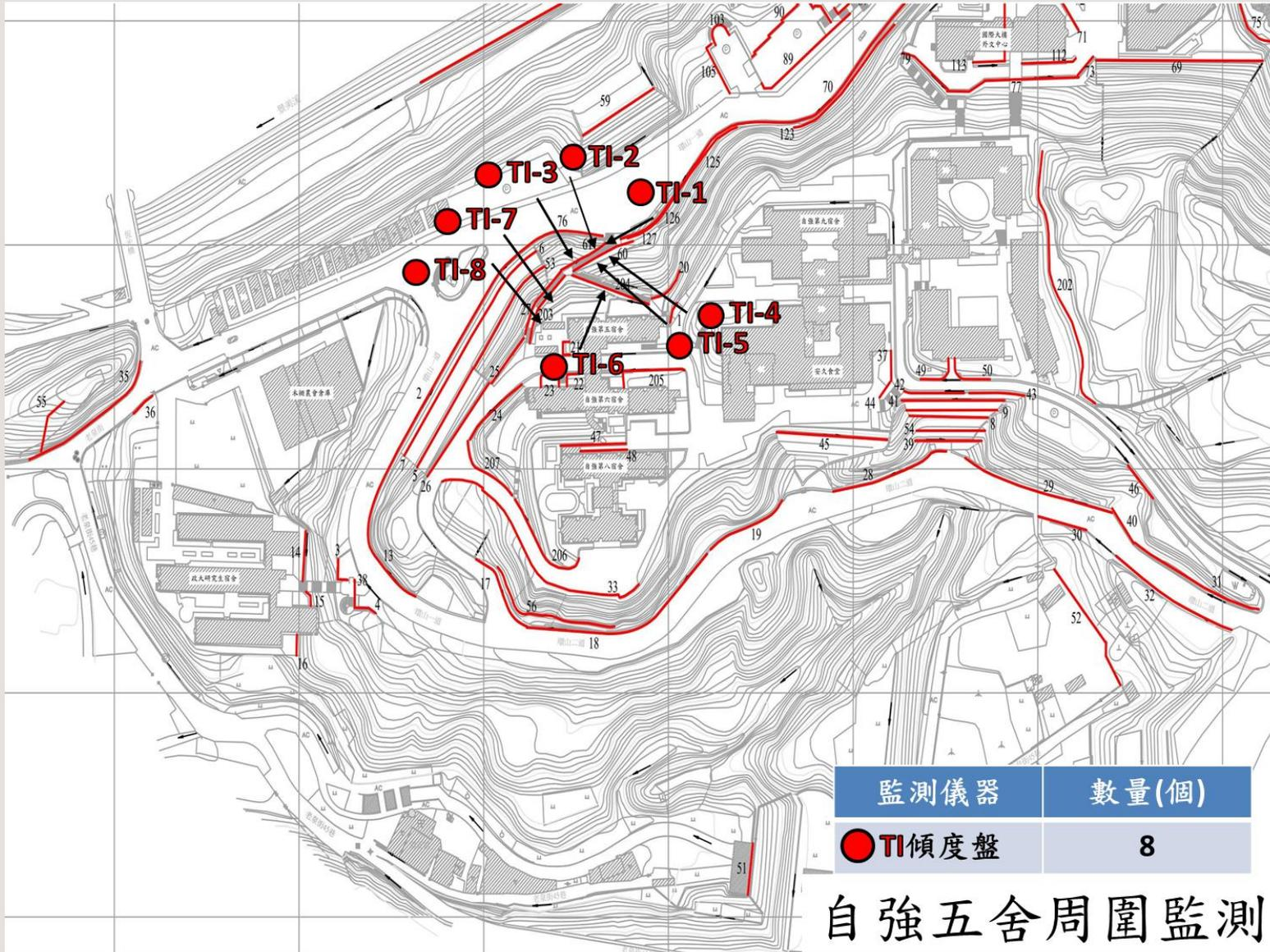
為確認好漢坡周遭邊坡穩定情形，已於周遭邊坡增設傾度盤進行整體監測，至本年11月，每月監測乙次。
