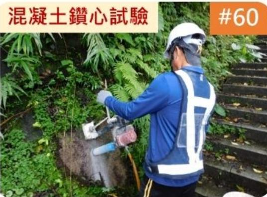
氯離子含量為 $0.461\text{kg/m}^3$ ，高於規範值，若混凝土含有過高的氯離子，可能造成鋼筋加速鏽蝕，導致整體擋土牆面逐漸損壞。
